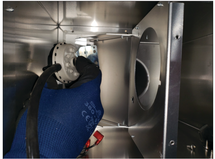
Figure 5.9, Retrait de l'interrupteur d'aspiration
