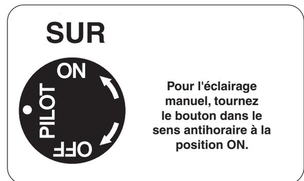
Fig. 40-3 Détail bouton de commande (SUR)
