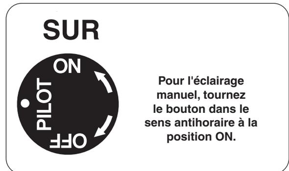
Fig. 28-1 Détail bouton de commande (SUR)
